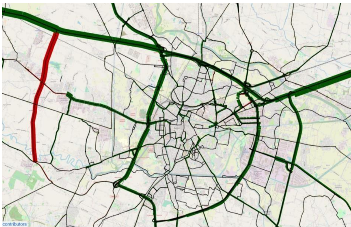
Flussogramma delle differenze dei flussi tra lo Scenario PUMS 2030 e lo Scenario attuale (veicoli nell'ora di punta del mattino – giorno feriale medio invernale)
